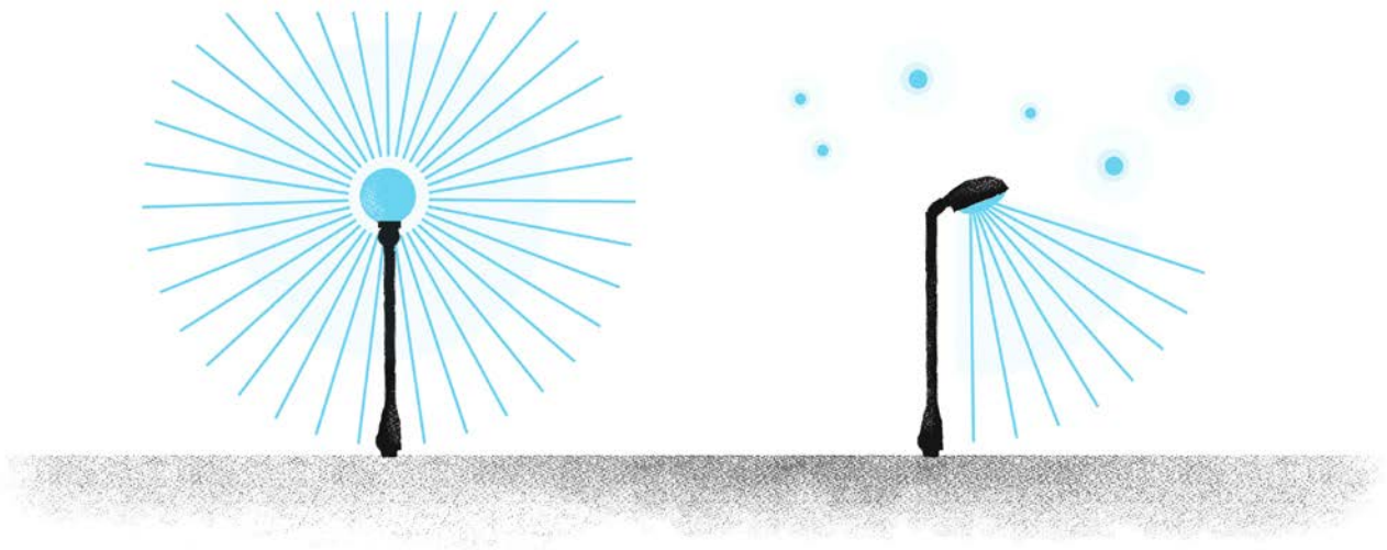
Rys. 7. Kierunek padania światła z lampy dla dwóch typów obudowy: obudowy typu kula (1) i obudowy z płaskim kloszem (2) Źródło: opracowanie własne
